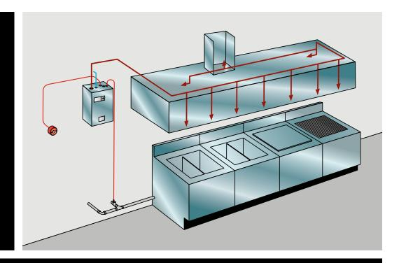
PRX™ LIQUID FIRE SUPPRESSANT ■ OVERLAPPING PROTECTION
